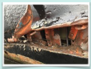
Die aufgerissene Außenhaut.
