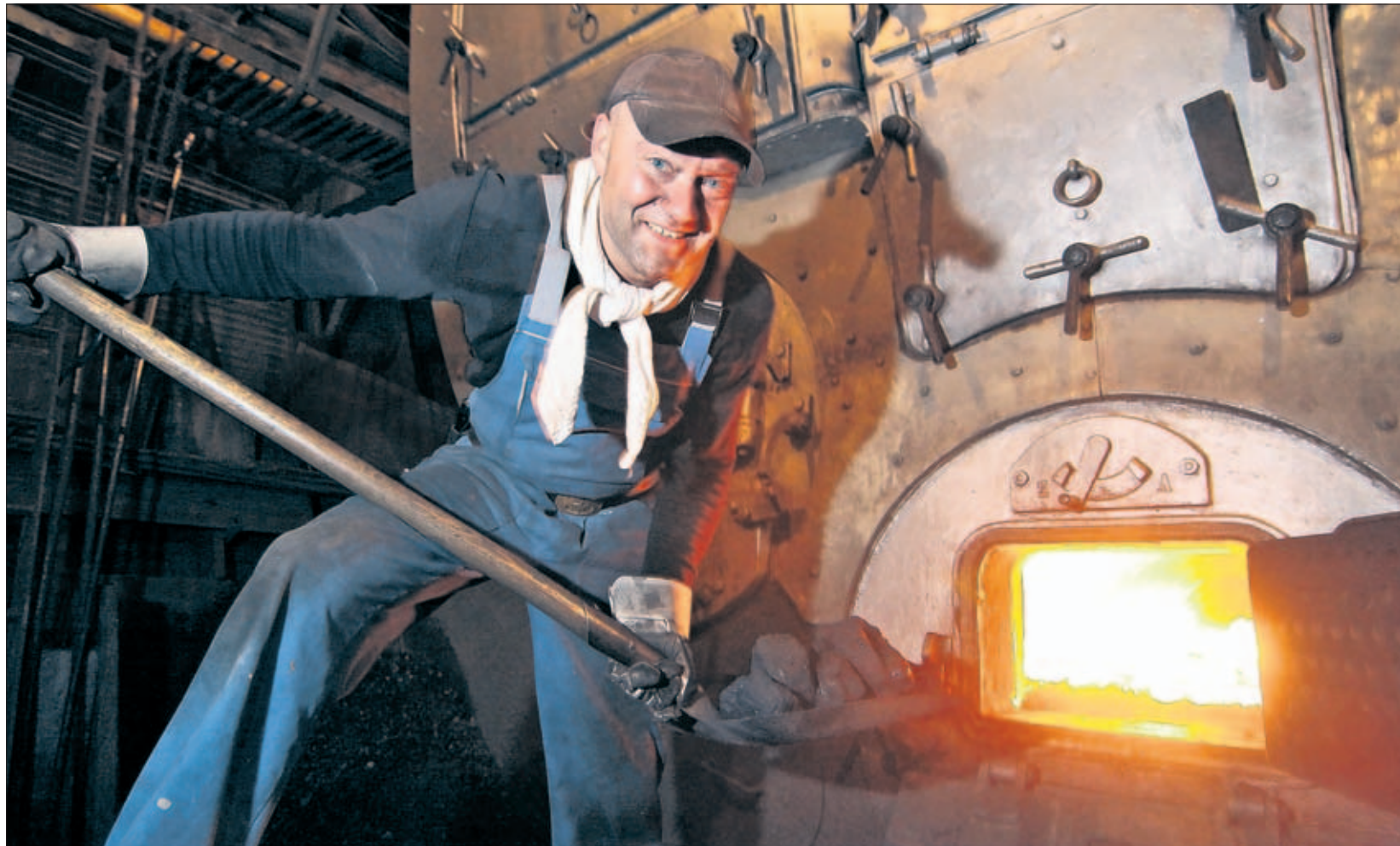
Unter Deck: Heizer André Fellbaum legt kräftig nach, damit immer ausreichend Druck auf dem Kessel ist.
