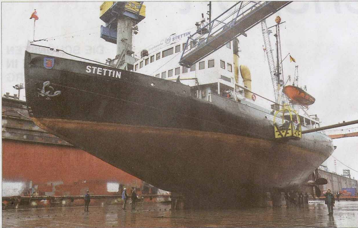
Der spitze Rumpf galt 1933 als modern: Der Eisbrecher kann so das Eis zerschneiden.
