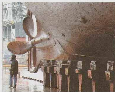
Im Dock zu sehen: Der Rumpf ist genietet, nicht geschweißt. Die in der Mitte angebrachte Opferanode verhindert Korrosion.
