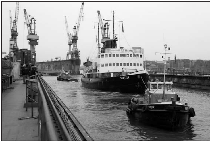
Zwei Schlepper positionieren das Schiff im Schwimmdock.
